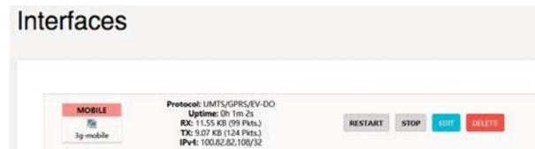
Protocol ändern in „UMTS/GPRS/EV-DO“. Tragen Sie unter dem Reiter „General Setup“ „PIN“ die PIN-Nummer Ihrer SIM-Karte ein. Lassen Sie das Eingabefeld leer für eine SIM-Karte ohne PIN. Tragen Sie die Zugangsdaten, APN, User und Passwort für die Datenübertragung in Ihrem Mobilfunknetz ein. Die Daten erhalten Sie von Ihrem Mobilfunkanbieter. Bei vielen Providern sind hier keine zusätzlichen Einträge für User und Passwort notwendig.
