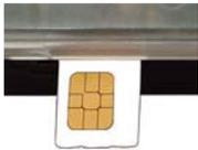
Stecken Sie Ihre SIM-Karte wie in der Abbildung links dargestellt ein bis sie einrastet. Legen Sie den Finger auf die SIM-Kartenverriegelung (links von der SIM-Karte) und schieben Sie die Verriegelung vorsichtig nach rechts bis sie einrastet.
